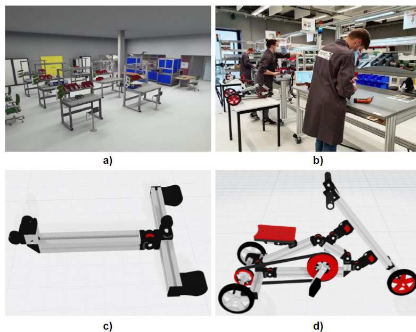
FIGURE 3.2 - Plate-forme industrielle et atelier de production flexible utilisés pour la construction des jeux de données. a) InHARD-DT et b) InHARD. c) Système final construit sur le premier poste de travail et utilisé dans le jeu de données InHARD-DT d) Vue d'ensemble du système final de l'ensemble du processus d'assemblage réalisé sur tous les postes de travail.
