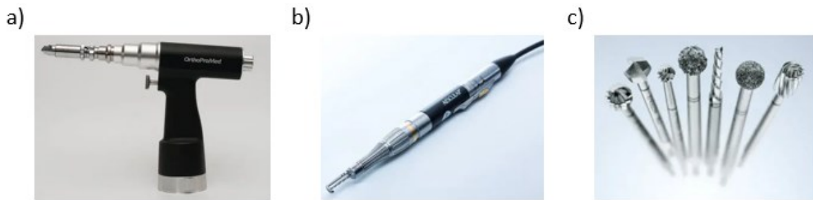
Figure 1-7 (a) Perceuse portable électrique (b) perceuse électrique pneumatique (c) Différentes fraises [13]
