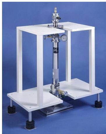
FIGURE II.14 – Photographie du cryostat JANIS utilisé pour les expériences de spectrométrie Mössbauer à basse température [12].
