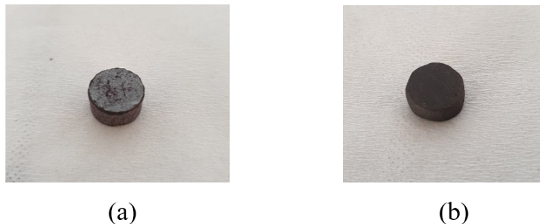
FIGURE II.3 – Photographies d'une pastille avant et après polissage.
