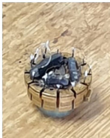
FIGURE II.4 – Porte échantillon de mesure de la résistivité électrique.
