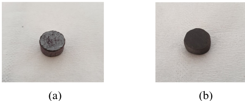
FIGURE II.3 – Photographies d'une pastille avant et après polissage.
