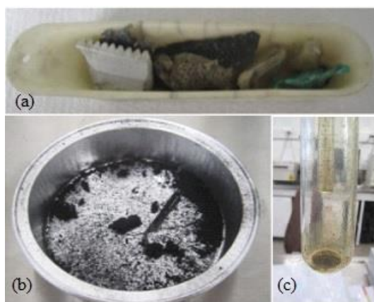
Figura 2.1- 3 (a) Muestras de DPV antes del proceso pirolítico, (b) residuos sólidos pirolíticos y (c) residuos líquidos pirolíticos.
