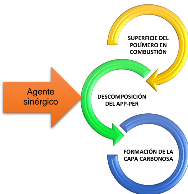
Figura 1. 21 Mecanismo de sistemas intumescentes con agentes sinérgicos
