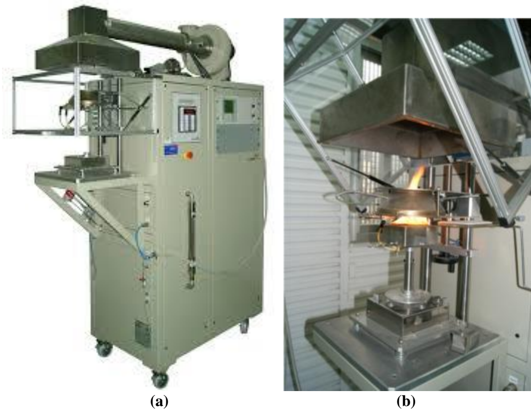
Figura 1. 24 Equipo del cono calorimétrico (a) y evaluación de la muestra en el cono Fuente: Extraído de INELTEC (22)
