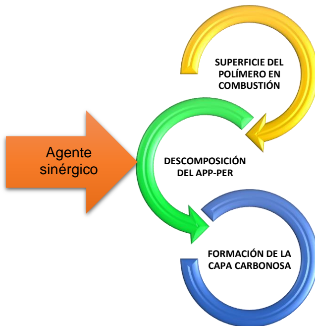
Figura 1. 21 Mecanismo de sistemas intumescentes con agentes sinérgicos
