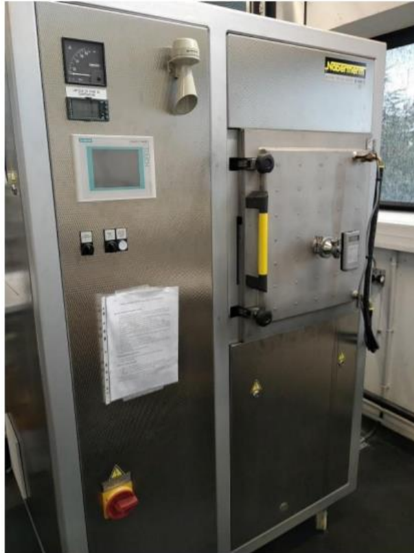
Figure II-4 : four à moufle à résistor en graphite pour les traitements hautes températures [81].
