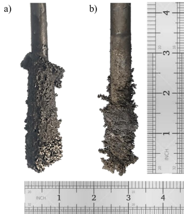
Figure V-19 : photographies d'un dépôt de titane sur une cathode en molybdène obtenu à partir de l'électro-dissolution d'une anode en oxycarbure de titane à 650 °C dans \text{LiCl-LiF-K}_2\text{TiF}_6 ( 1,23 \times 10^{-3} \text{ mol.cm}^{-3} ) a) sans nettoyage, b) après nettoyage aux ultrasons.
