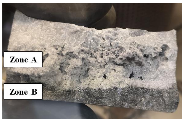
Figure IV-30 : photographie d'une coupe transversale du sel solidifié LiCl-KCl-K_2TiF_6 après les études de chimie analytique.
