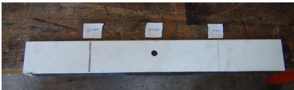
Figure 75 : Cornière peinte avec trou et rainures avant son passage au four
