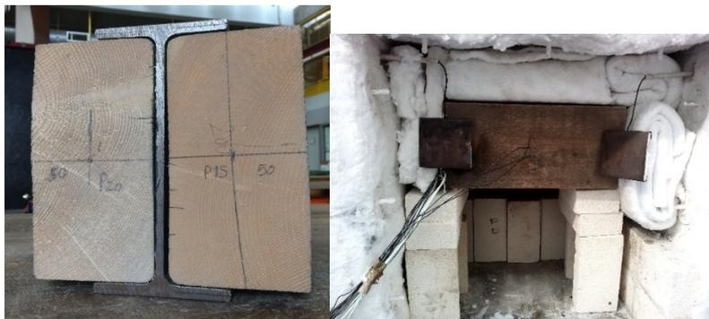
Figure 138 : Profilé IPE 200 avec âme protégée par deux madriers sapin parfaitement ajustés en hauteur
