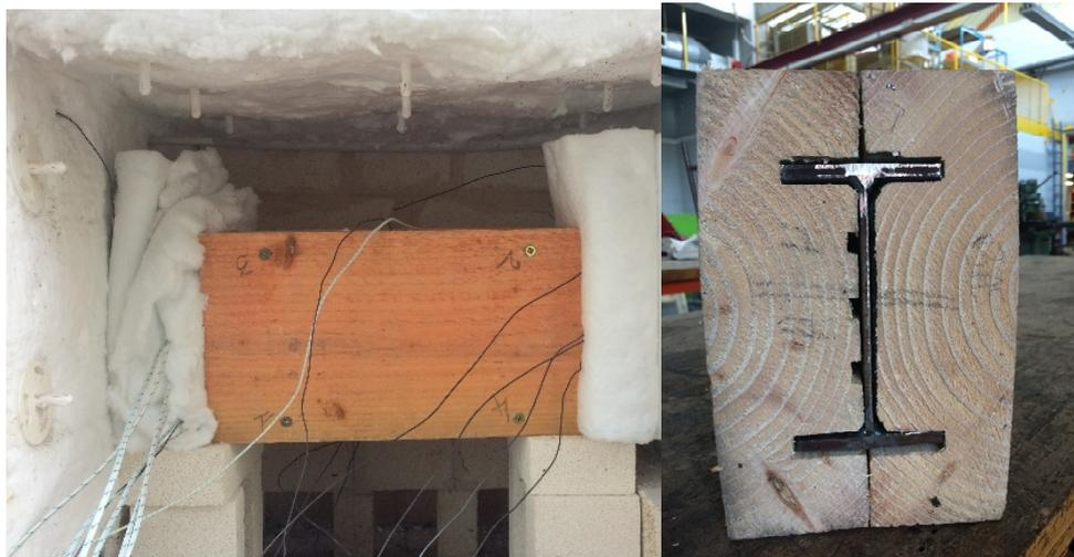
Figure 141 : Poutre IPE 140 avec bastaing en pin, enrobage de 40 mm
