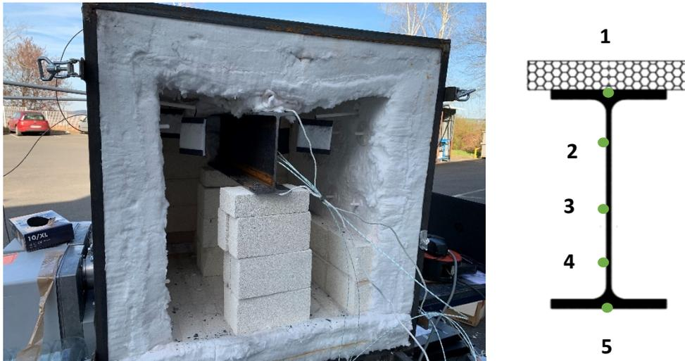
Figure 118 : Disposition de l'IPE 200 dans le four et positions des thermocouples
