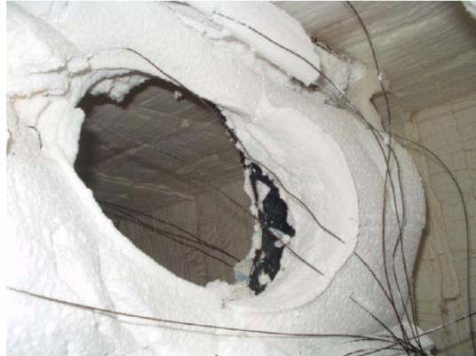
Figure 29 : Aspect de la peinture lors des essais de Bailey sur les poutre cellulaires (BAILEY, 2004)
