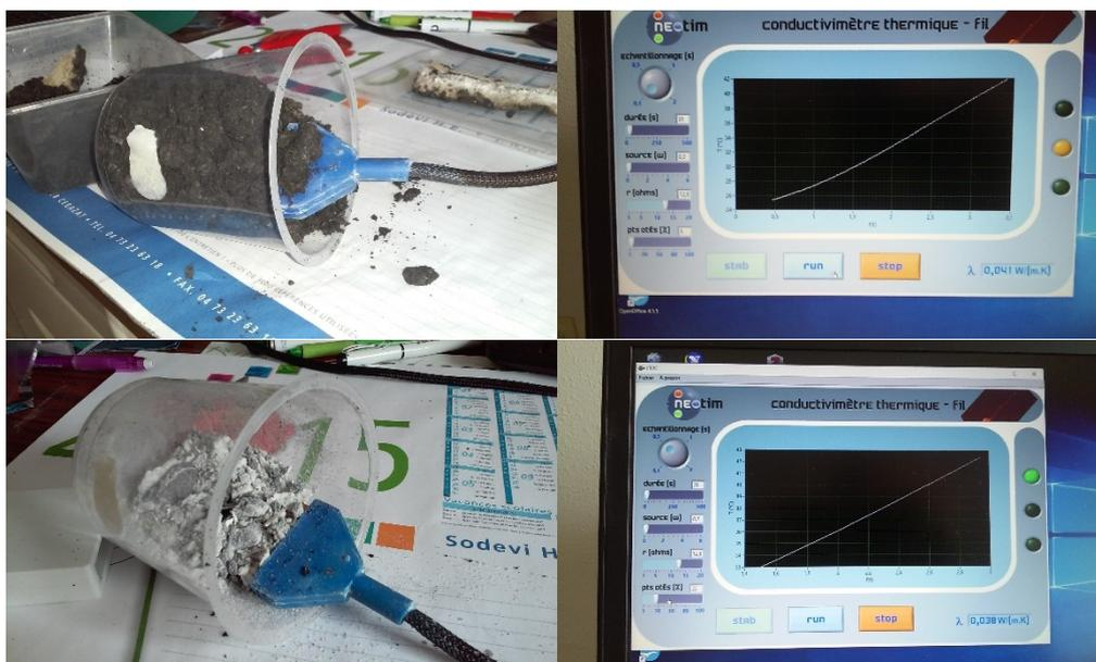
Figure 99 : Mesure de la conductivité thermique des différentes meringues après essais au feu
