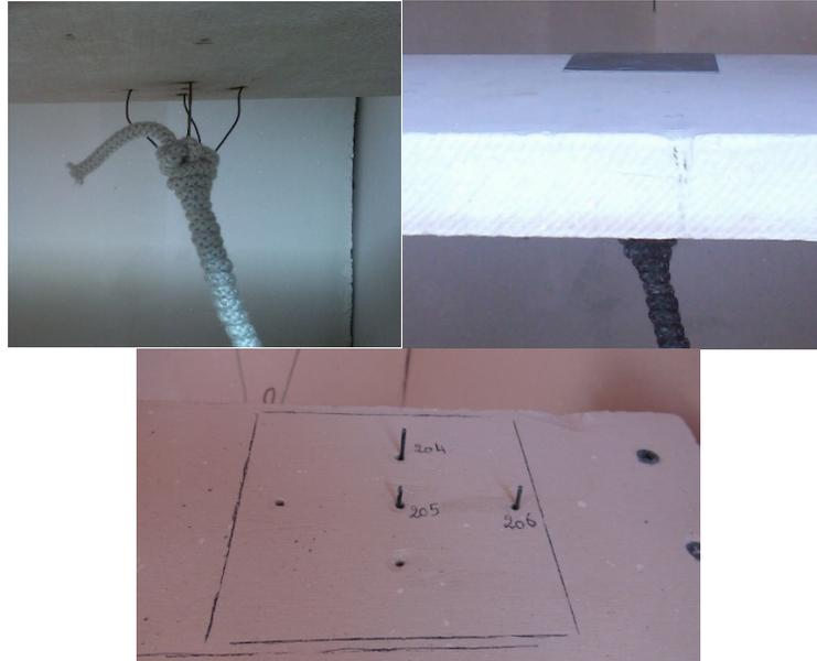
Figure 67 : Positionnement des thermocouples pour la mesure des températures de la plaque
