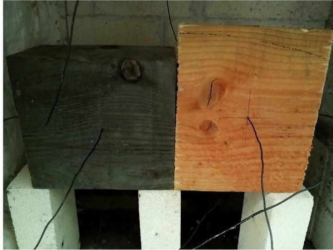
Figure 144 : Madrier sapin (à droite) et madrier pin (à gauche) dans le four pour un essai au feu
