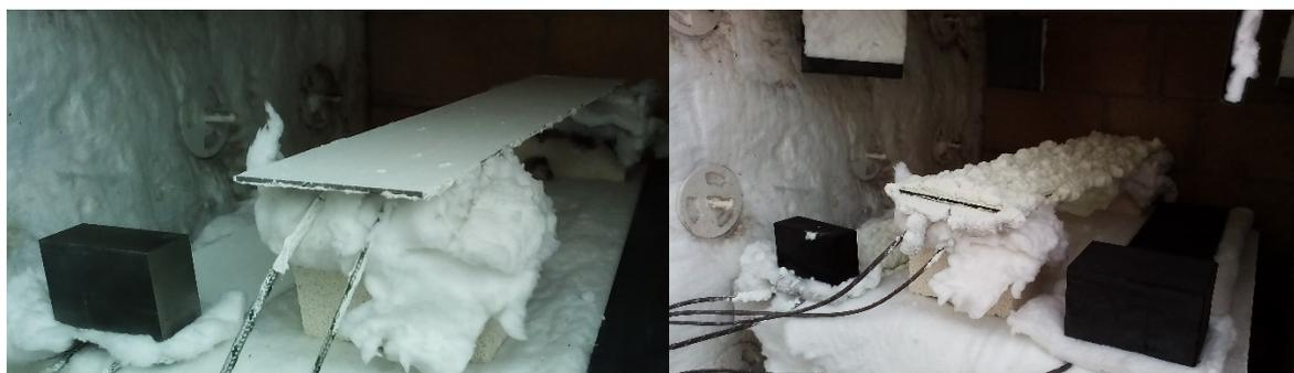
Figure 100 : Plaque peinte disposée sur le plat et exposée sur toutes les faces avant et après exposition au feu (essai 1)
