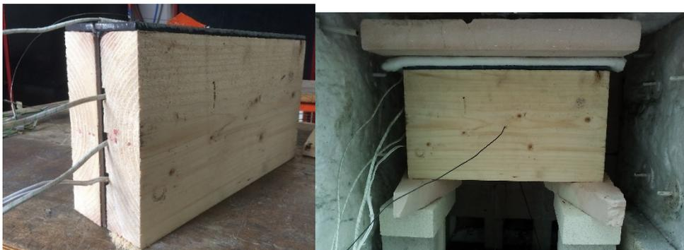
Figure 134 : Vue de la poutre T 230 protégée par du pin
