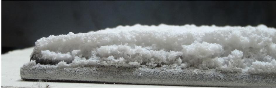
Figure 79 : Plaque d'acier peinte après passage au four à brûleurs fioul
