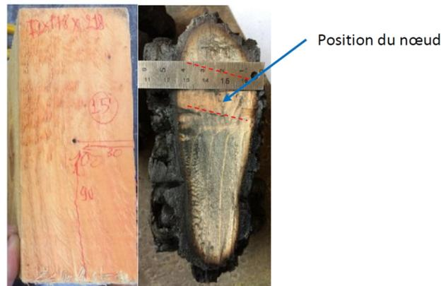
Figure 153 : Mesure de l'épaisseur résiduelle de bois après exposition au feu (pin)
