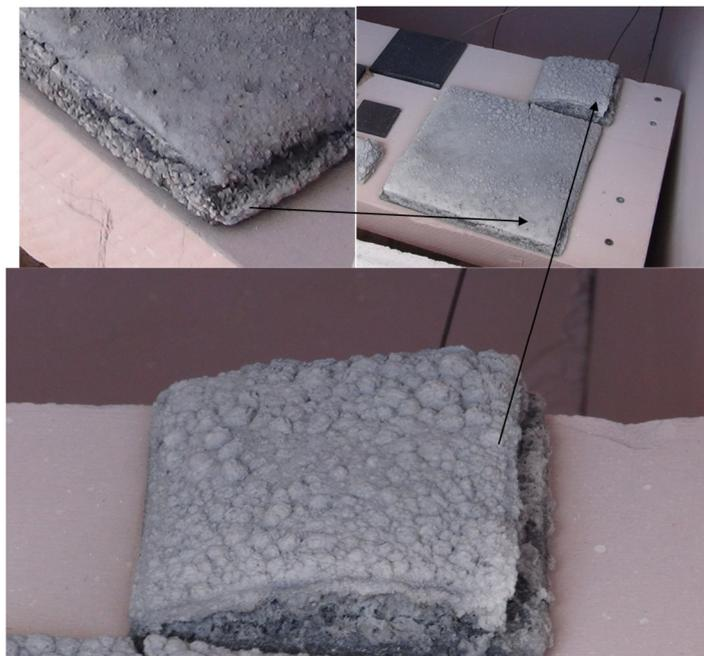
Figure 78 : Développement de la meringue en bordure des plaques 200x200 et 100x100
