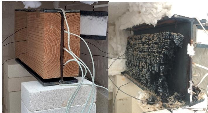
Figure 124 : Profilé bois-acier dans le four avant et après l'essai (IPE 240)
