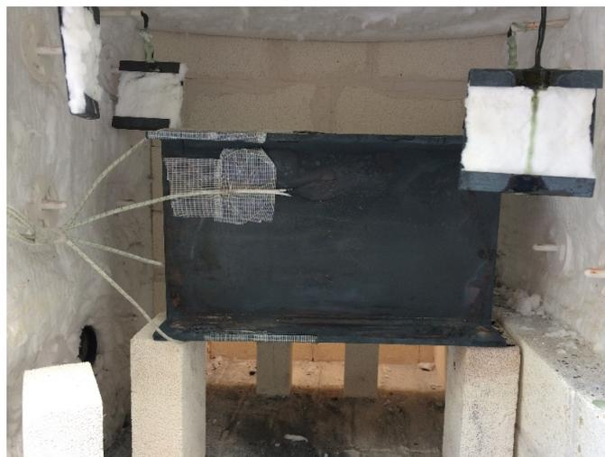
Figure 115 : Disposition horizontale de l'IPE 240 dans le four
