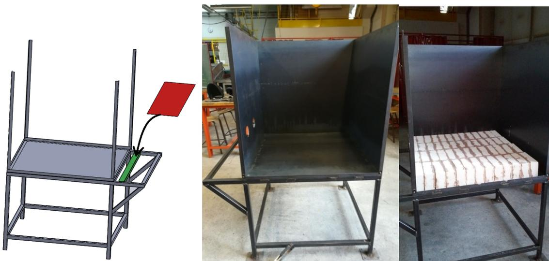
Réalisation de la structure en acier et construction de la sole
