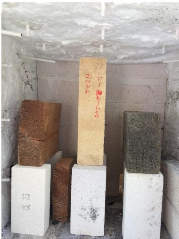
Figure 152 : Echantillons de bois dans le four acier
