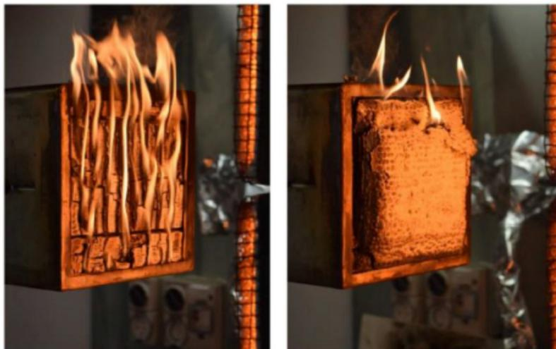
Figure 25 : Echantillon de bois non protégé et protégé par peinture intumescence soumis à une source de chaleur (LUCHERINI, et al., 2019)
