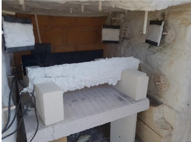
Figure 101 : Plaque peinte disposée sur le chant et exposée sur toutes les faces après exposition au feu (essai 2)
