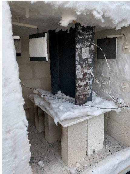
Figure 111 : IPE 240 non protégé disposé verticalement dans le four
