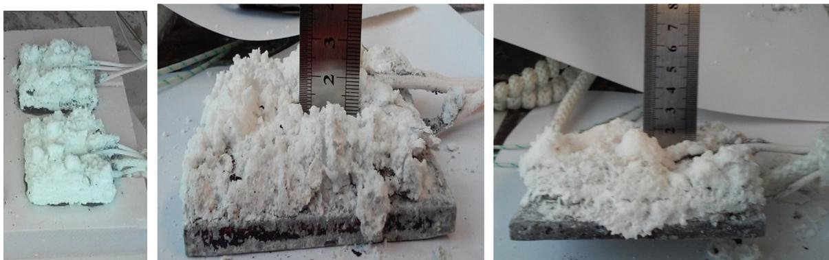
Plaque acier100x100 épaisseur de 8 mm avec 375  $\mu\text{m}$  de peinture
