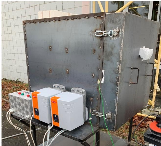
Figure 66 : Four acier version finale avec les deux brûleurs sur le côté gauche
