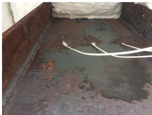
Figure 110 : Soudure des thermocouples sur l'âme de l'IPE 240
