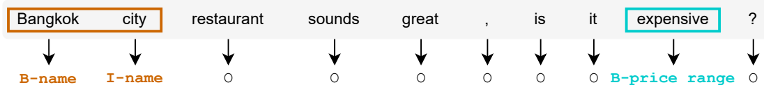
FIGURE 2.3 – Exemple d’un énoncé utilisateur dans le domaine des restaurants, annoté pour la tâche de détection des slots au format IOB.
