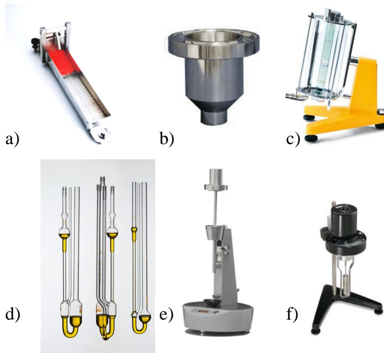
Fig. I.27 – a) Consistomètre de Bostwick [125], b) Coupe d'écoulement[126], c) Viscosimètre à chute de bille[127], d) Viscosimètres capillaires[128], e) Viscosimètre de Laray (à tige tombante)[129], f) Viscosimètre rotatif (Brookfield)[130].
