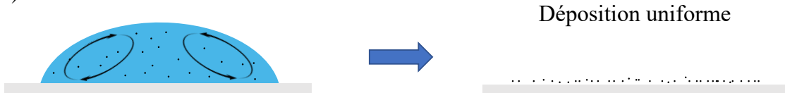
Fig. I.11 Évaporation d'une goutte colloïdale dans des conditions ambiantes standard : (a) le flux sortant d'une gouttelette crée une tache de type anneau de café ; (b) La recirculation du flux de Marangoni crée un motif uniforme.
