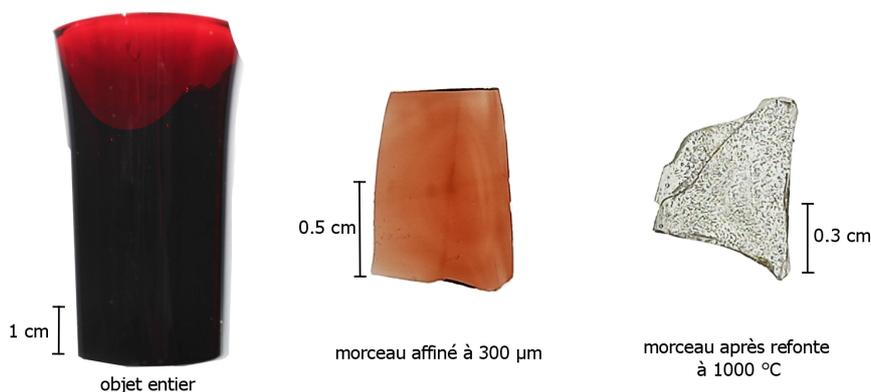
FIGURE 4.5 Essai de laboratoire réalisé par Baccarat pour la production de rouge au cuivre, et morceau de ce verre après avoir été refondu.
