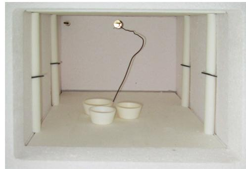
FIGURE 4.1 Photo du four servant à réaliser les striking. Les morceaux de verre sont placés dans les coupelles d'alumine visibles sur la photo, en dessous du thermocouple de calibration. Le thermocouple interne au four est visible au fond à gauche.
