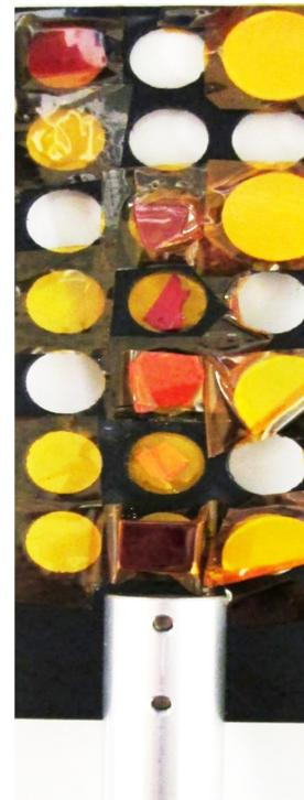
FIGURE 2.7 Porte-échantillon multiple utilisé pour les mesures XAS aux seuils K du cuivre et de l'étain sur la ligne SAMBA.
