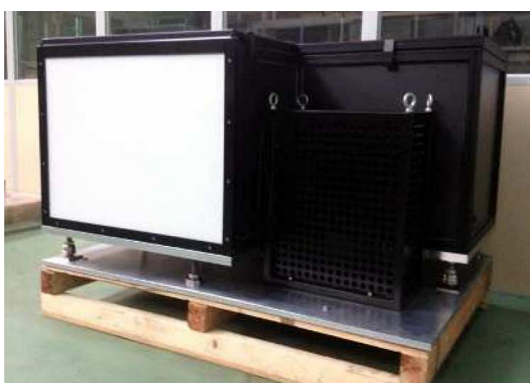
(a) Photographie du détecteur initial (avec en blanc le scintillateur).
