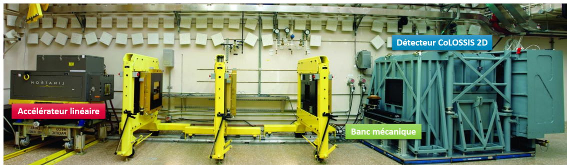
FIGURE 2.9 – Tomographe du LLNL (accélérateur de 9 MeV) [46].
