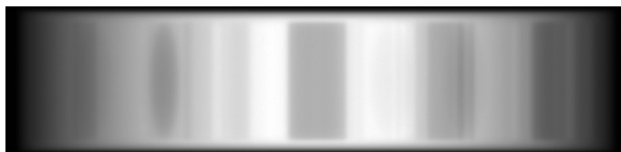
FIGURE 4.6 – Projection simulée numéro 411 du fantôme (projection bruitée et floutée).
