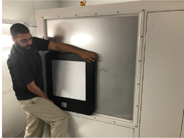
FIGURE 2.8 – Comparaison du scintillateur GOS de 1000 \times 1000 \text{ mm}^2 de Jesse Garant par rapport à un détecteur à panneau plat type, d'environ 300 \times 300 \text{ mm}^2 [44].
