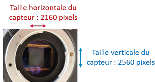
FIGURE 3.11 – Vue rapprochée de la matrice du capteur Zyla.
