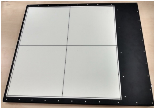
(a) Détecteur à panneau plat iRay avec en blanc la zone sensible et la partie noire contient l'électronique de lecture.
