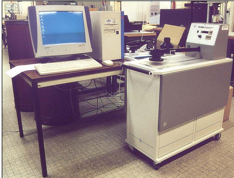
Figure III-9 : Photographie du FX3300, perméamètre à air.
