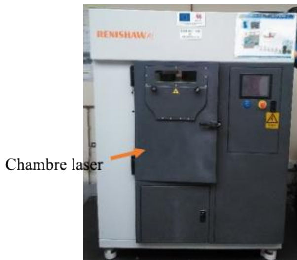
Figure II. 3. Dispositif laser utilisé pour l'élaboration de revêtements épais.
