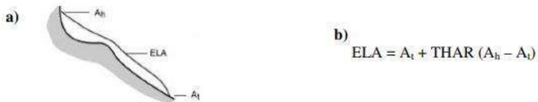
Figure 2.6 : Méthode de reconstitution de la LEG utilisant l'approche THAR. (a) Diagramme de la méthode : A_h représente la tête du glacier et A_t le pied de ce dernier ; (b) Équation permettant de calculer la paléo-LEG. Pour la méthode MGE, la valeur THAR est égale à 0,5. Extrait de Porter et al. (2001).
