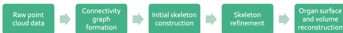
Figure 3.4: Chaîne de traitement générale pour la reconstitution d'un modèle de plante à partir de nuages de points. Cette chaîne de traitement inclut la construction d'un squelette. A partir de CHAUDHURY et Christophe GODIN, 2020a.
