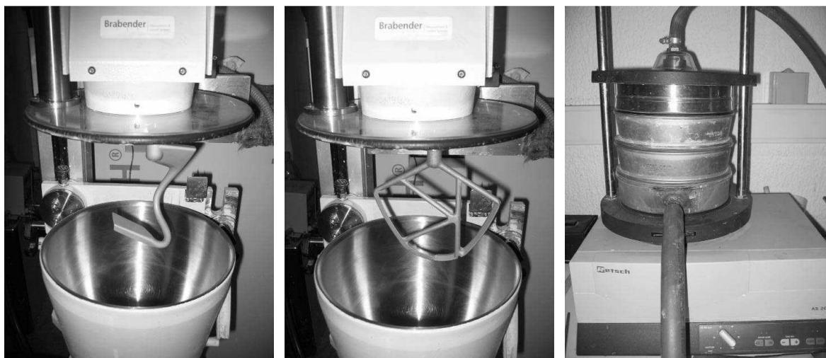
**Fig. II.6. Dispositif de développement et d'extraction du gluten.**
