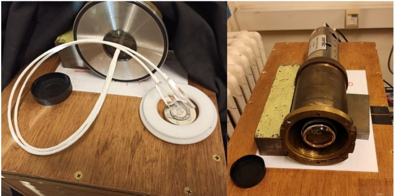
FIGURE 4.6 – Banc de test du détecteur  $\beta$  avec la partie scintillante, à gauche, et le photomultiplicateur seul, à droite. Des draps ont été utilisés pour éviter les fuites de lumière et le bruit de fond. Le PMT ayant changé entre ces tests et le montage sur COeCO, une brève vérification du signal a été effectuée avec le nouveau tube, directement sur le système.
