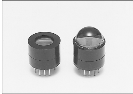
FIGURE 3.20 – Tube photomultiplicateur à 8 étages modèle R7400U, à gauche, et R7401 avec une lentille hémisphérique, à droite. Pour assurer le passage entre les fibres et la photocathode et boucher l'espace visible entre la photocathode et les bords du tube, un disque en silicone a été utilisé.
