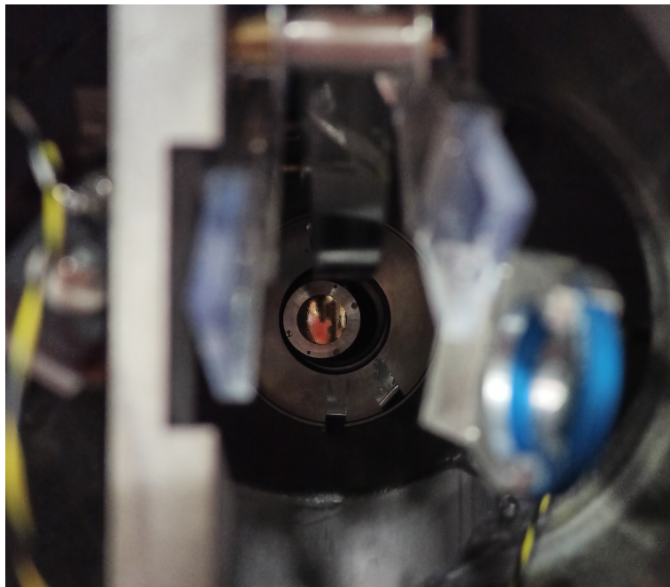
FIGURE 3.15 – Décalage de la jonction silicium-lithium par rapport à l'axe de la chambre, au centre de la deuxième bobine. Le détecteur est monté sur un rail pour le faire avancer dans l'axe et le décalage visible ici change pendant son déplacement. Il est donc certainement dû à une torsion du doigt froid sur lequel est monté le détecteur.
