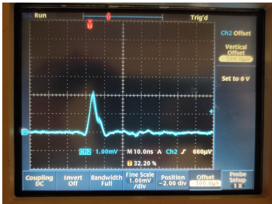
FIGURE 4.7 – Signal en amplitude de la réponse en photoélectron unique obtenue avec une source de ^{207}\text{Bi} en faisant une moyenne sur 16 signaux. La présence d'un rebond peut indiquer une mauvaise collection de la lumière ou bien une détérioration avec le temps du tube photomultiplicateur.
