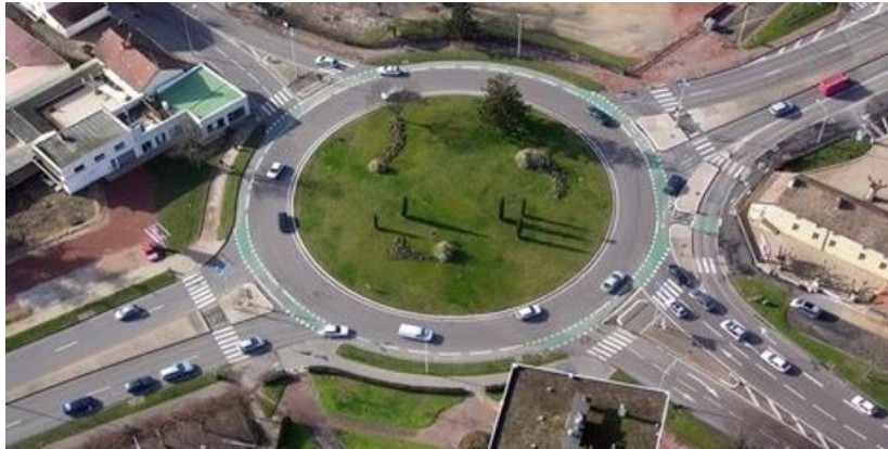
Figure 1.16 – Exemple d'intersection circulaire de type giratoire
