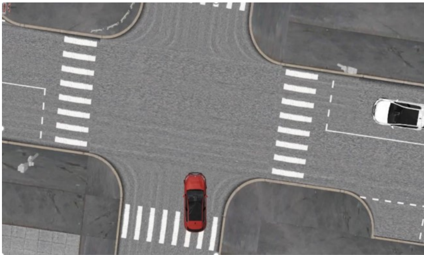
Figure 5.20 – Scénario de test sous SCANeR Studio : l'égo-véhicule (en rouge) suit son chemin de référence le menant à tourner à gauche à l'intersection où le véhicule blanc va lui couper la route
