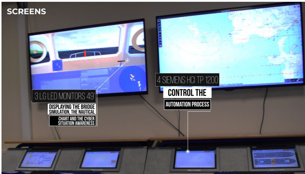
FIGURE IV.7 – Passerelle du navire simulé à l'aide des logiciels Bridge-Command (simulateur de navigation) à gauche et d'OpenCPN (cartographie maritime) à droite.
