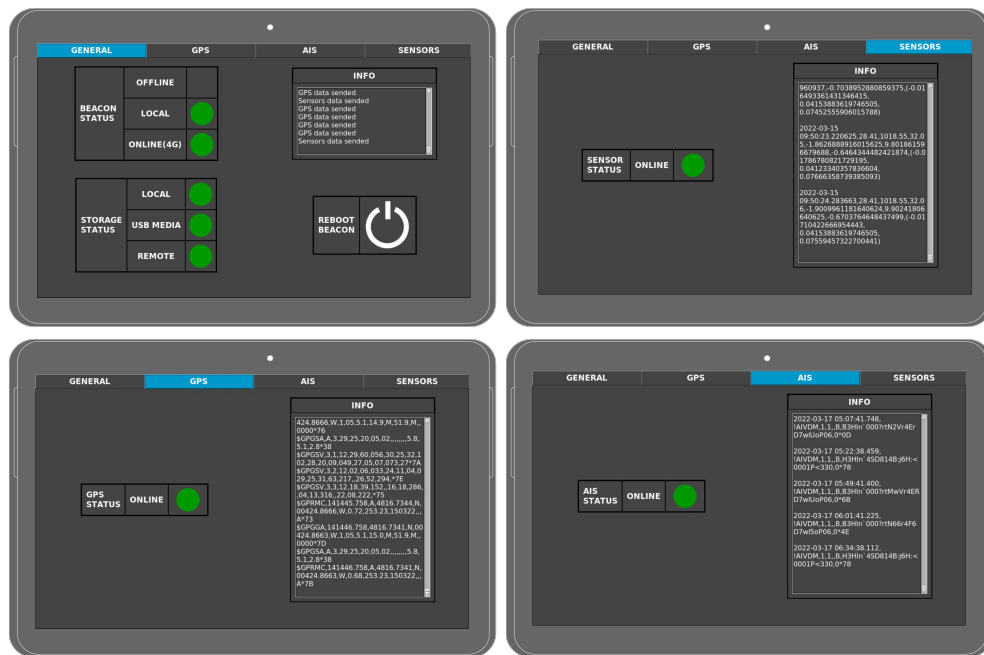
FIGURE V.14 – Exemples d’IHM développées et dédiées aux opérations à bord pour la balise embarquée HAPPINESS.
