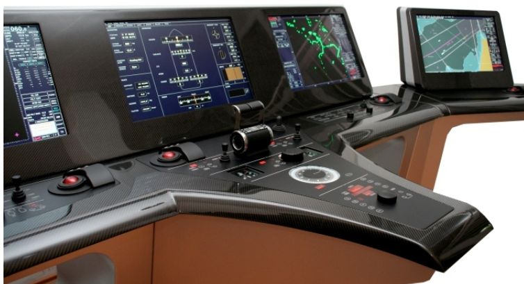
FIGURE II.6 – Exemple de Systèmes de Navigations Intégrés (INS) en passerelle du navire. (Source wikipédia : https://en.wikipedia.org/wiki/Navigation )
