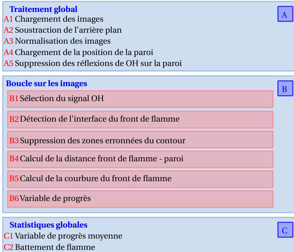
FIGURE A.4 – Schéma des principales étapes de post-traitement des images de PLIF-OH.
