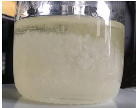
Figure 3-11 : Formation massive de germes observée dans le bécher par barreau magnétique en l'absence de couvercle après 2 minutes d'agitation
