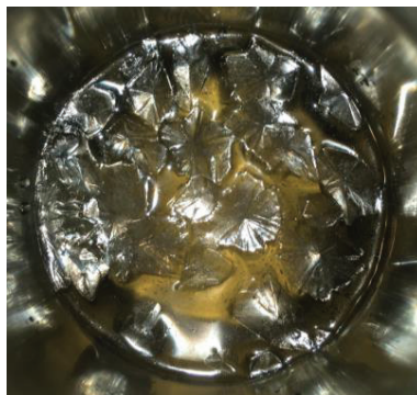
Figure 3-12 : Ensemencement involontaire sur la surface libre de l'échantillon de Xylitol après 10 heures d'exposition à l'atmosphère du laboratoire
