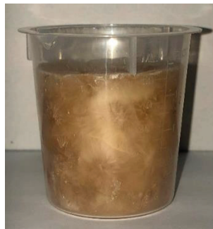
Figure 3-2 : Echantillon de Xylitol dégradé, en fin de campagne expérimentale
