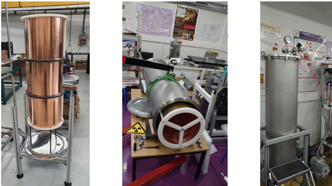
FIGURE 4.16 – Compteur Proportionnel Cylindrique. Gauche : la cathode positionnée sur le support de la CPC; Centre : Cathode placée à l'intérieur du réservoir en acier lors de l'installation au LP2i-Bordeaux; Droite : CPC installée et connectée aux systèmes de gestion du gaz et d'acquisition des données
