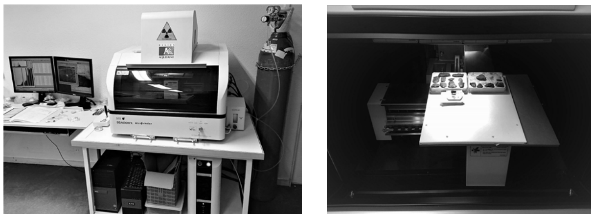
Figure 038 : Spectromètre de fluorescence X SEA 6000vx de l'IRAMAT CRP2A, vue générale et exemple d'échantillons archéologiques positionnés sur la platine.
