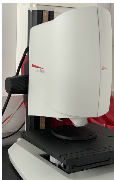
Figure 2-9 : Photographie du microscope confocal utilisé pour étudier les dépôts de matériaux 2D sur les transistors.
