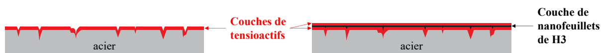
Figure 4-44 : Représentation schématique du revêtement par des couches de tensioactifs (gauche) et de tensioactifs en présence de nanofeuillets de H3 (droite) d'un substrat rugueux en acier.
