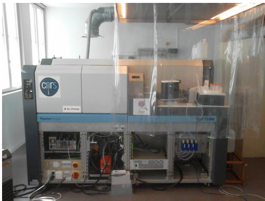
Figure 4.1 : Spectromètre de masse à source plasma à multicollecion (MC-ICP-MS) de l'IPGP qui a été utilisé pour l'analyse des isotopes du bore.
