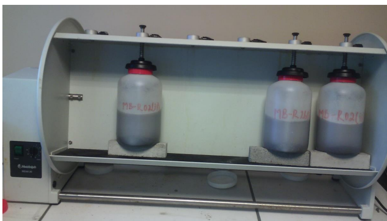
FIGURE 3.17 – Dispositif expérimental de rotation pour les analyses de lixiviation
