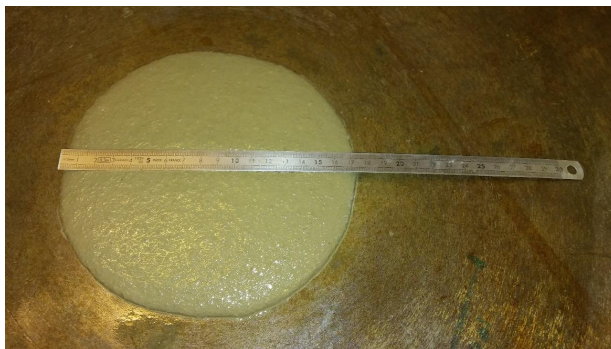
FIGURE 4.5 – Dispositif expérimental de mesure de l'étalement sur la table à secousses
