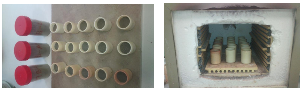
FIGURE 3.12 – Mode opératoire de la calcination des mâchefers d'incinération
