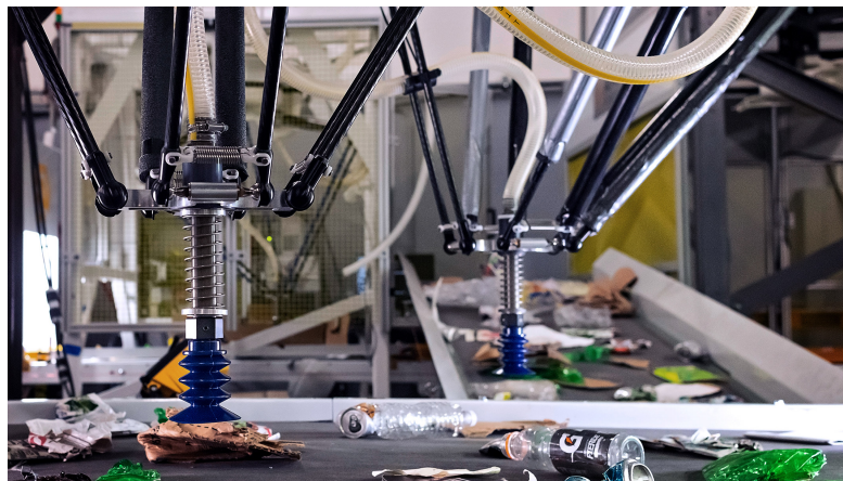
FIGURE 5.1 – Exemple de robots parallèles dans un centre de tri de déchets. Il s'agit de robots Ix4 vendus par Omron équipés de la plateforme rigide P30. Le préhenseur est un système d'aspiration, ce qui est adapté pour des déchets globalement plats et légers. [Pransky 20].
