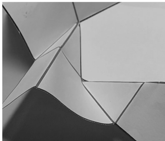
FIGURE 2.6 – Illustration des déformations du papier lors du pliage du Flasher.
