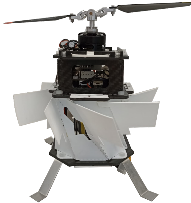
FIGURE 5.20 – Illustration du drone avec la structure origami composée de la tour et des ailerons.
