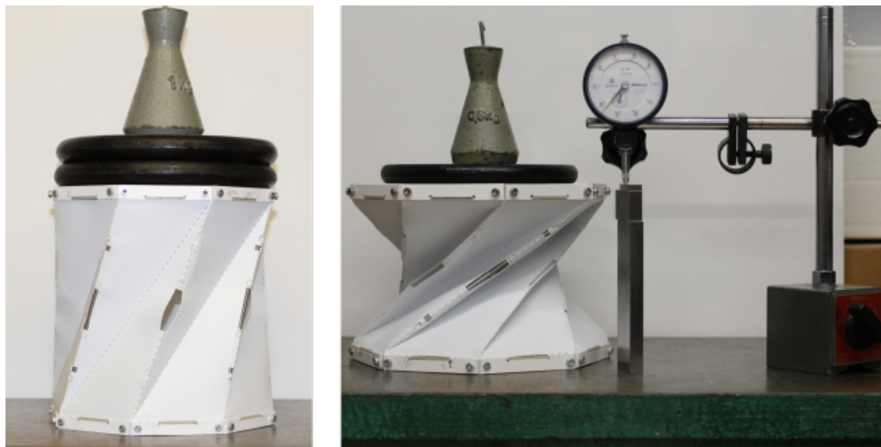
FIGURE 4.4 – Illustration de l’application progressive des poids pour définir la force de basculement (gauche). Mesure de la raideur en configuration basse (droite).
