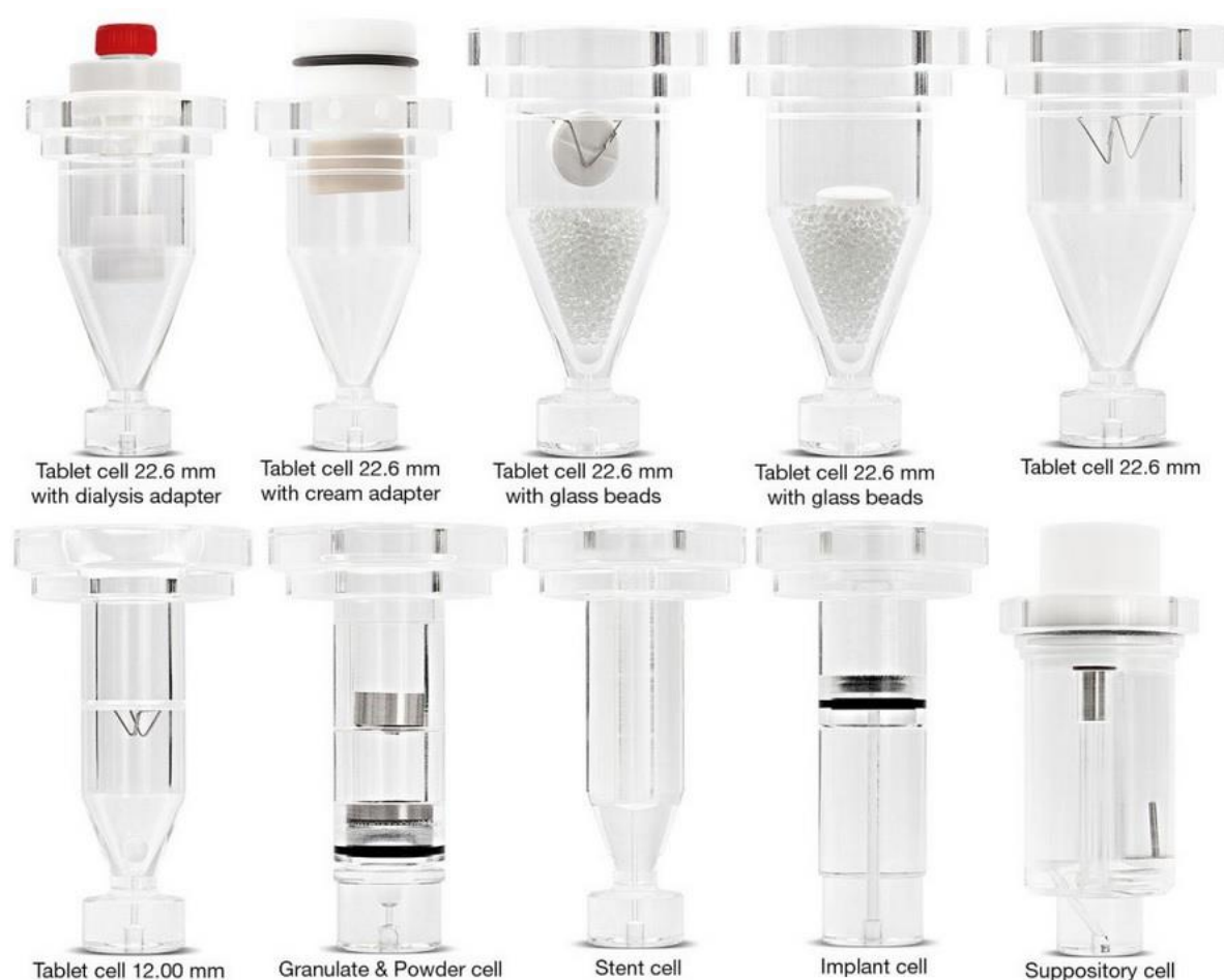
Figure 25 Les types de cellules à flux pour les différentes formes pharmaceutiques (72)
