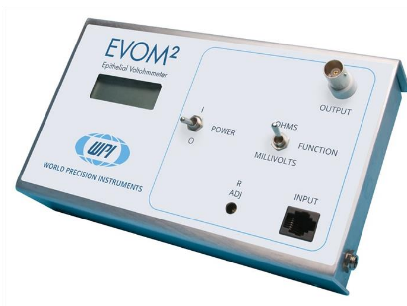
Figure 4 Voltmètre épithélial (EVOM 2 World Instrument Precision TM ) pour la détermination de la résistance électrique trans-épithéliale
