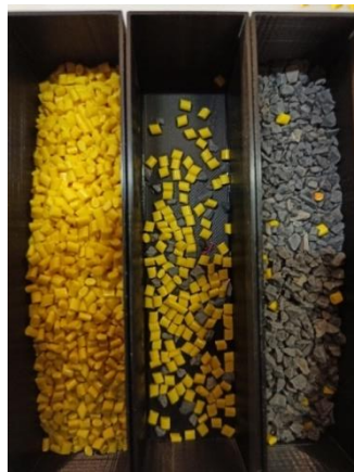
Figure IV-19. Résultat de séparation du mélange ABS / PVC obtenus avec la configuration d'électrodes en parallèle II, (Paroi en PVC, U = \pm 16 kV, A_m = 70\% ).
