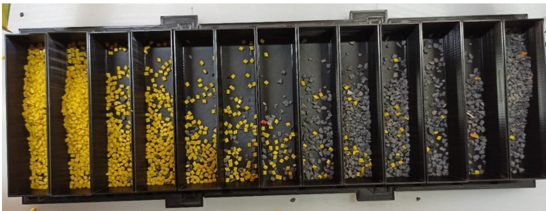
Figure IV-23. Résultat de séparation du mélange ABS / PVC obtenu avec la configuration des électrodes en forme de « \Lambda » (Paroi en PVC, U = \pm 16 kV, Am = 70\% ).
