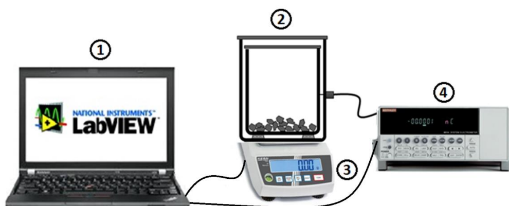
Figure II-10. Système de mesure de charge. (1) PC équipé d'une carte d'acquisition de données ; (2) Cage de Faraday ; (3) Balance ; (4) Electromètre.
