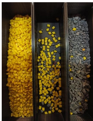
Figure IV-25. Résultat de la séparation du mélange ABS / PVC obtenu avec la configuration des électrodes en forme de « V » (Paroi en PVC, t = 3 min, U = \pm 16 kV, A_m = 70\% ).
