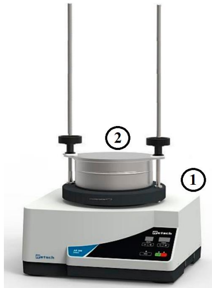
Figure I-10. Dispositif de charge triboélectrique vibrant de marque Retsch; (1) Dispositif vibrant ; (2) Récipient en acier inoxydable (Diam. : 160 mm) [103].
