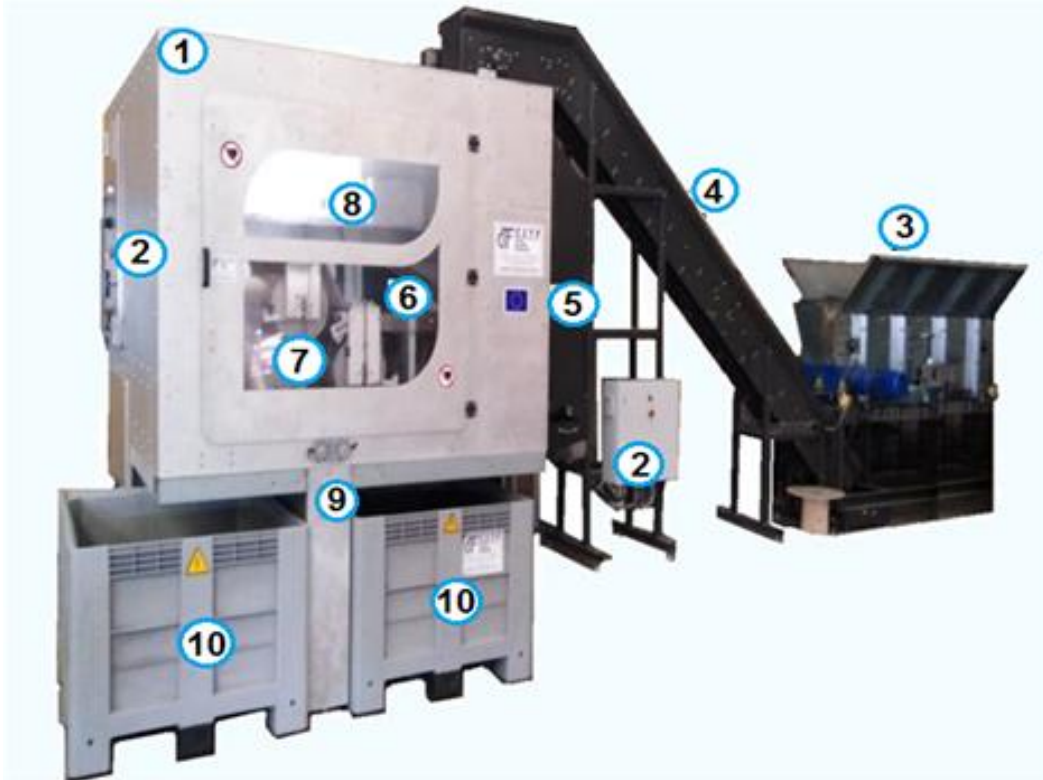
Figure I-33. Séparateur électrostatique industriel de série CP100 ; 1 : châssis ; 2 : armoires électriques ; 3 : pré-broyeur ; 4 : convoyeur ; 5 : broyeur granulateur ; 6 : table vibrante ; 7 : électrodes ; 8 : convoyeur ; 9 : vis sans fin ; 10 : caisses palettes [115].
