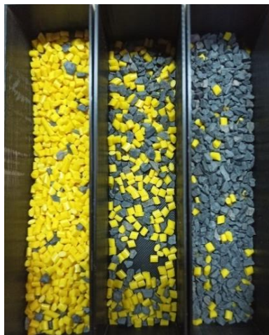
Figure IV-21. Résultat de séparation du mélange ABS / PVC obtenu avec la configuration d'électrodes en forme de « V » (Paroi en PVC, U = \pm 16 kV, Am = 70\% ).
