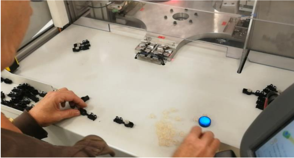
Figure 14. L'opérateur assemble les pièces (la pièce blanche s'emboîte dans la pièce noire).
