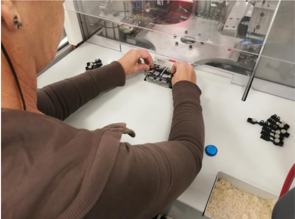
Figure 15. L'opérateur tend au cobot (via un plateau) les deux pièces préfabriquées.
