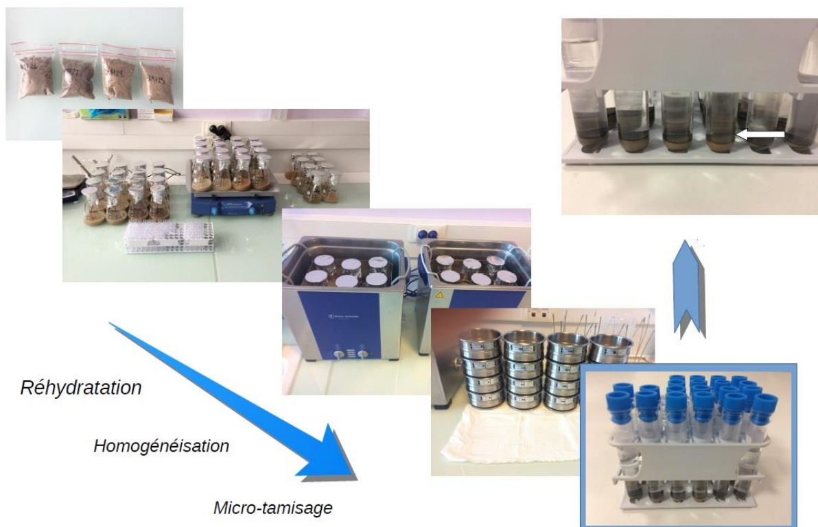
Figure 9 Les différentes étapes du protocole RHM pour la concentration et l'extraction d'œufs d'helminthes gastro-intestinaux, depuis des échantillons de sédiment bruts jusqu'à l'obtention de fractions à la granulométrie contrôlée.
