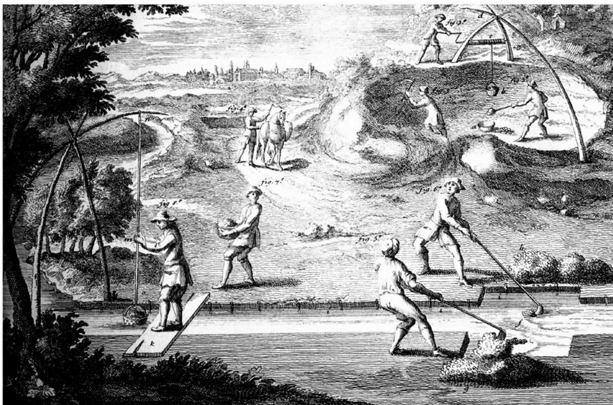
En haut, à droite, extraction du minerai. Au centre la mine extraite est conduite au lavoir à dos de mulet. En bas, à droite, deux ouvriers lavent la mine dans un bassin. À gauche, l'ouvrier passe au crible, appelé « égrappoir », une charge de minerai déjà lavé.
