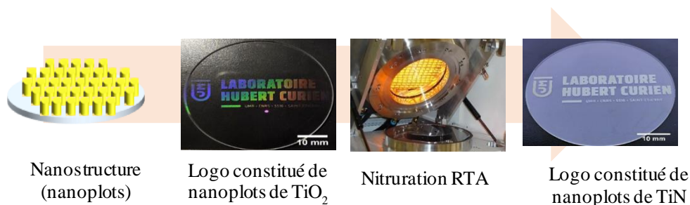
Figure 3.20 : Étapes d'élaboration d'un logo en TiN en combinant les différents procédés de lithographie colloïdale et photo-masquage
