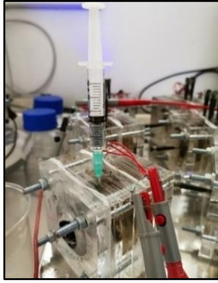
Figure VI-4 : Injection du polluant ciblé (NS ou ions Pb^{2+} ) dans le biocapteur PACM contenant une solution d'eau usée fraîche avec 10 mM de NaAc.
