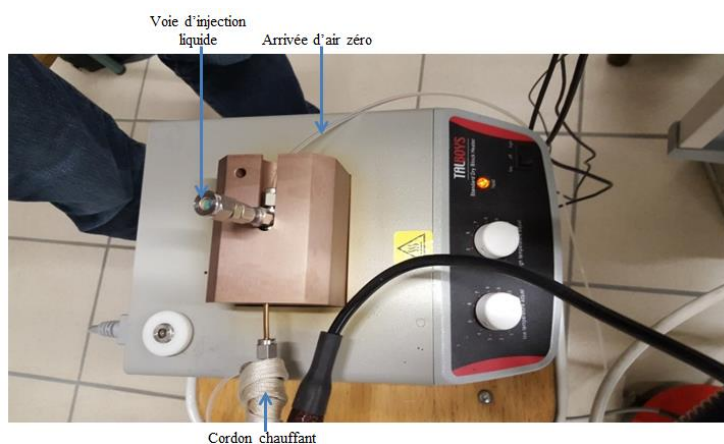
Figure 2-7 : système d'injection liquide chauffé
