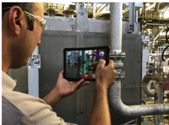
FIGURE 6 – Visualisation du Jumeau Numérique d’une turbine de gaz en RA à l’emplacement de la turbine réelle pour l’aide à la maintenance par [69]
