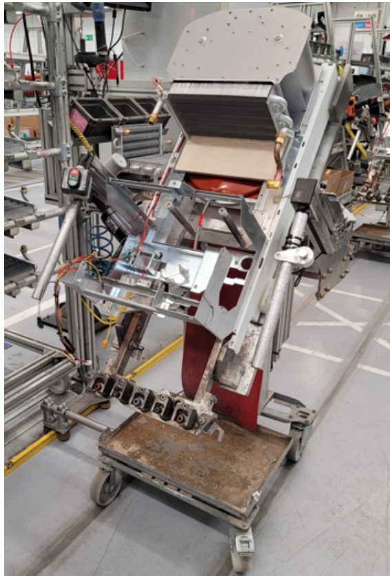
FIGURE 3.2 – Photographie d'un chariot de support chaudière de l'usine elm.leblanc de Drancy
