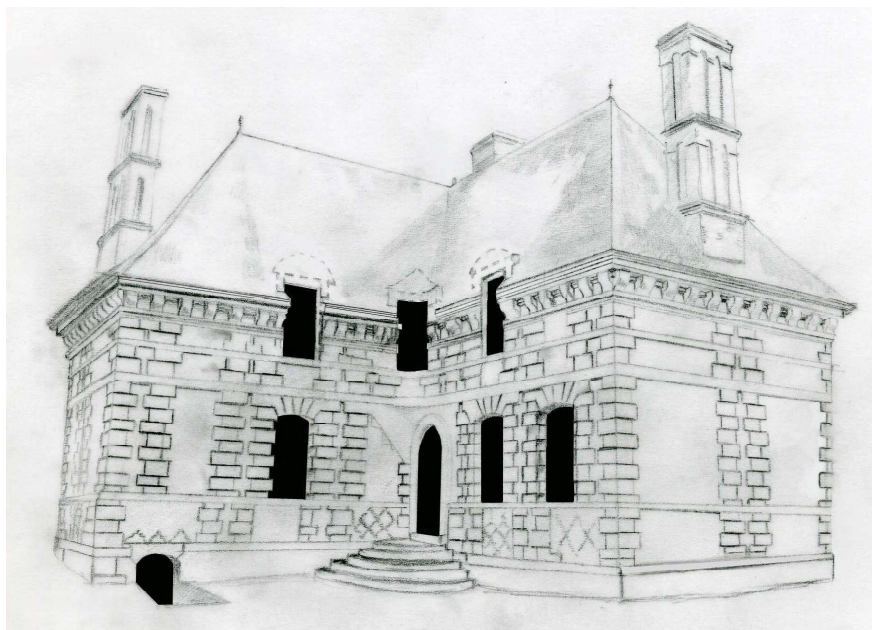
Fig. 423. Jouveaux vers 1590. Elévation restituée de la maison seigneuriale, façade sur cour. (seule la forme des frontons des lucarnes passantes n'est pas attestée)
