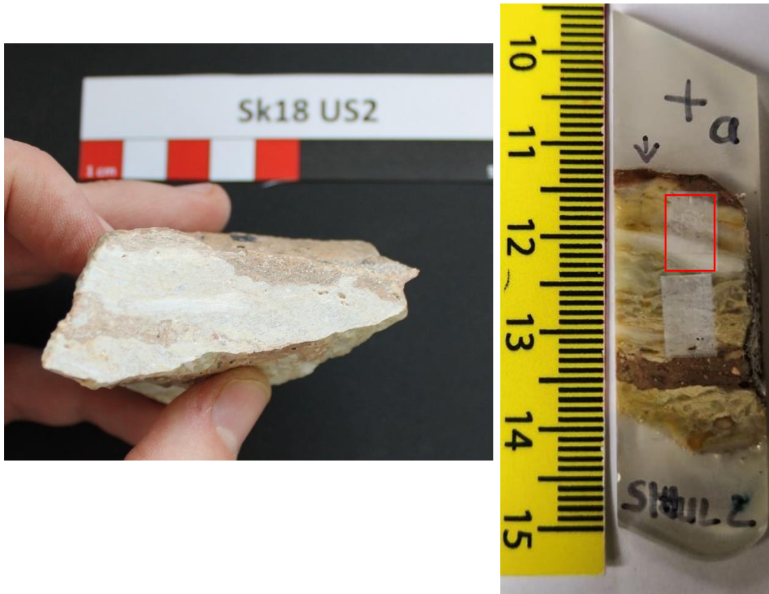
Figure V-3 : Coupe de l'échantillon SK18US2 à gauche, tranche après mise en résine et découpe à droite. L'encadré rouge indique la fenêtre d'ablation.
