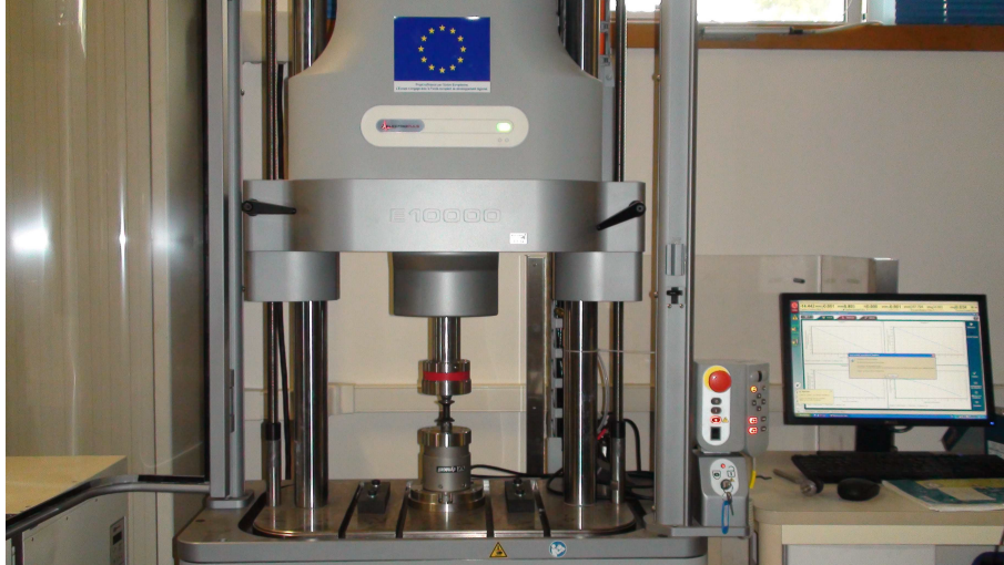
FIGURE 2.2 – Machine de traction-torsion Instron E10000, avec une éprouvette de fatigue montée.
