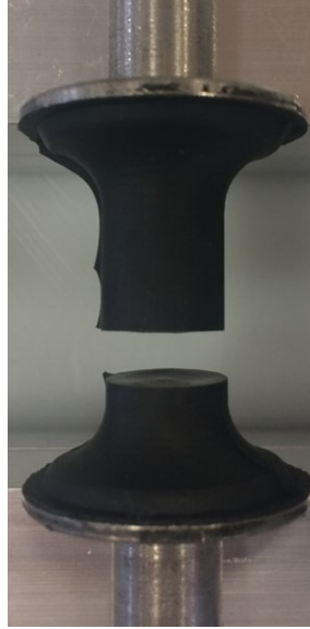
FIGURE 3.2 – Éprouvette de fatigue rompue après un test de traction-torsion de conditions de chargements ( U_{\max} = 28 mm, \alpha_{\max} = 76^\circ ). La fissure s’est amorcée (et propagée) perpendiculairement à la direction de traction.
