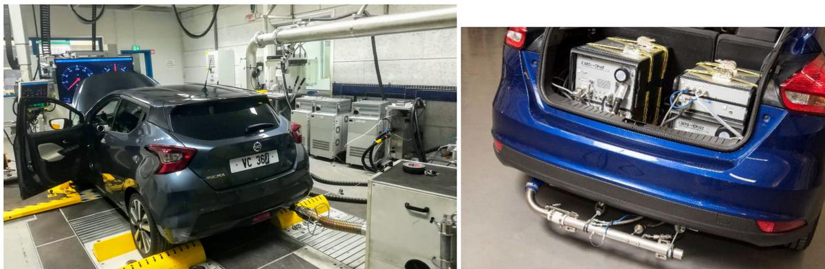
((a)) Véhicule sur banc à rouleaux en laboratoire. ((b)) PEMS à l'arrière d'un véhicule.
