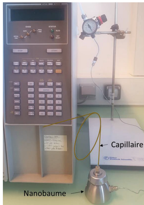
Figure A-2 - Montage pour la réalisation du greffage avec HPC.
