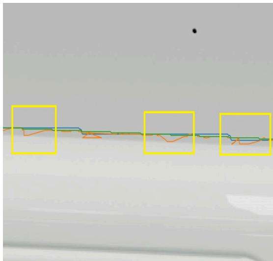
(b) Erreurs dues à l'ombre d'un objet. La courbe orange est le résultat de la méthode, la courbe bleue l'initialisation et la courbe verte, la vérité terrain.
