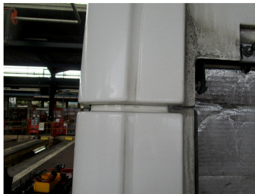
FIGURE 1.1 – Exemple d'une zone d'un bus où le jeu entre deux pièces (manchette et coins rond droit) doit être réglé
