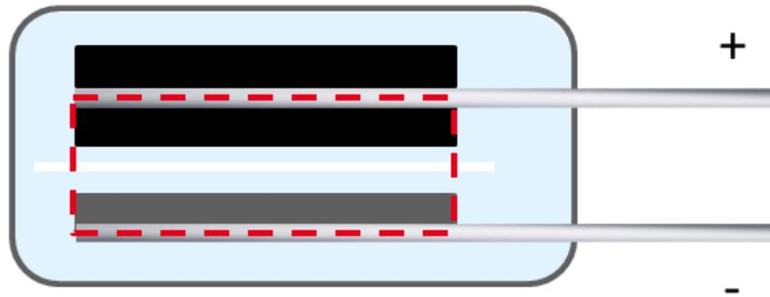
Figure 2.3 : Schéma d'une cellule KIC graphite/AC en tranche pour représenter le cœur électrochimique défini dans cette étude
