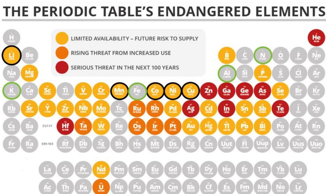
Figure 1.12 : Tableau périodique des éléments menacés d'épuisement (source : ACS Green Chemistry Institute) avec les matériaux constitutifs d'une LIB (entourés en noir) et ceux d'une KIB (entourés en vert)
