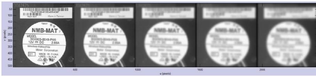
Figure 25: Détection des points d'intérêts à l'aide d'opération de floutage successif de la scène. D'après (Havard, 2018).
