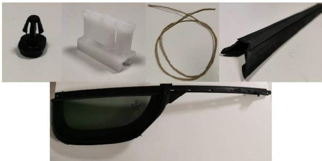
Figure 99: Les composants et le sous-ensemble. De gauche à droite et de haut en bas : clip noir, clip blanc, cordelette, coulisse et glace de custode.
