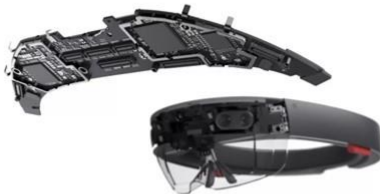
Figure 17: Le système de Calcul de l'Hololens 1. Documentation Microsoft.
